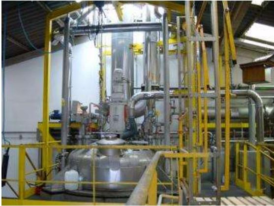
*Réacteur de 10 m<sup>3</sup> pour la fabrication des résines en fusion*
