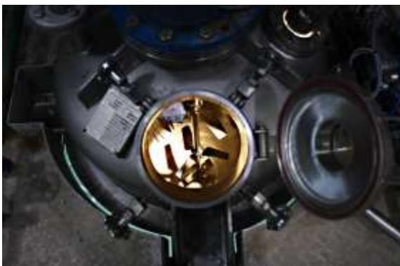
*Atomiseur Pilote : Débit : 1 kilo eau/heure // Batch minimum : 50 grammes de matière sèche
